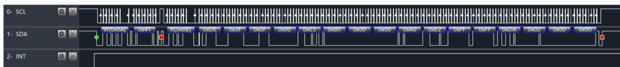
Рисунок 6. Схема чтения кадра данных в I2C
