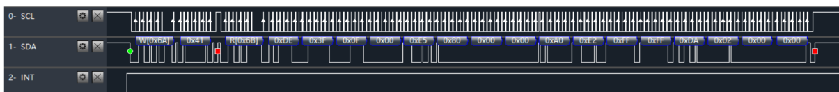
Рисунок 6. Схема чтения кадра данных в I2C
